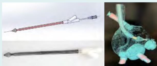
Conception, prototypage et évaluation d'une nouvelle canule d'assistance cardio-respiratoire (projet BioArtLung)
